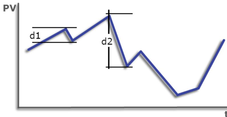
Figura 3.12 – Exemplo de ocorrências de reversões no VTP10-H.
