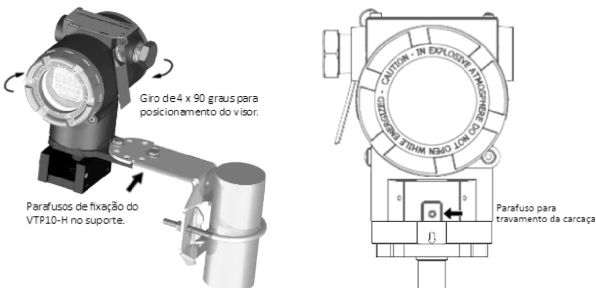
Figura 2.3 – Fixação do VTP10-H no suporte e rotação da carcaça 4 x 90° com travamento.
