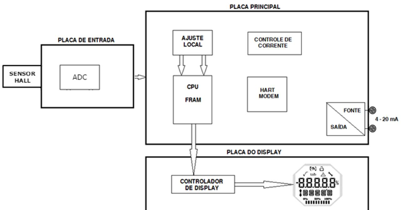
Figura 1.1 - Diagrama de blocos do VTP10-H.
