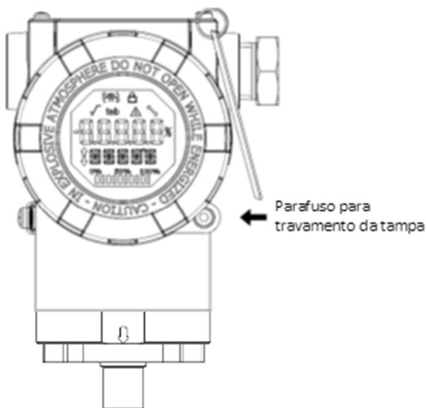
Figura 2.2 – Trava da tampa com visor.
