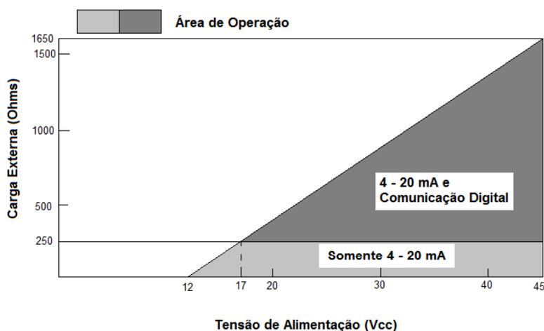
Figura 3.8 – Curva de carga do VTP10-H.
