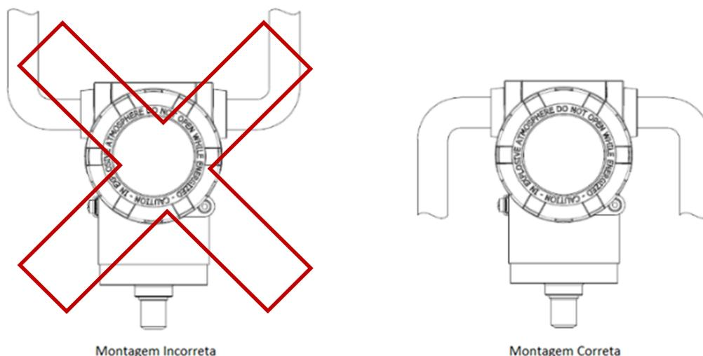
Figura 2.10 – Esquema de instalação do eletroduto.
