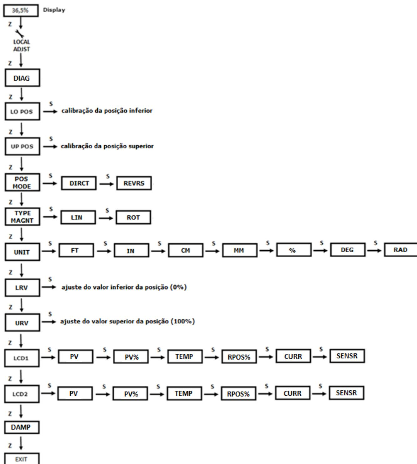
Figura 3.3 – Árvore de programação do ajuste local.
