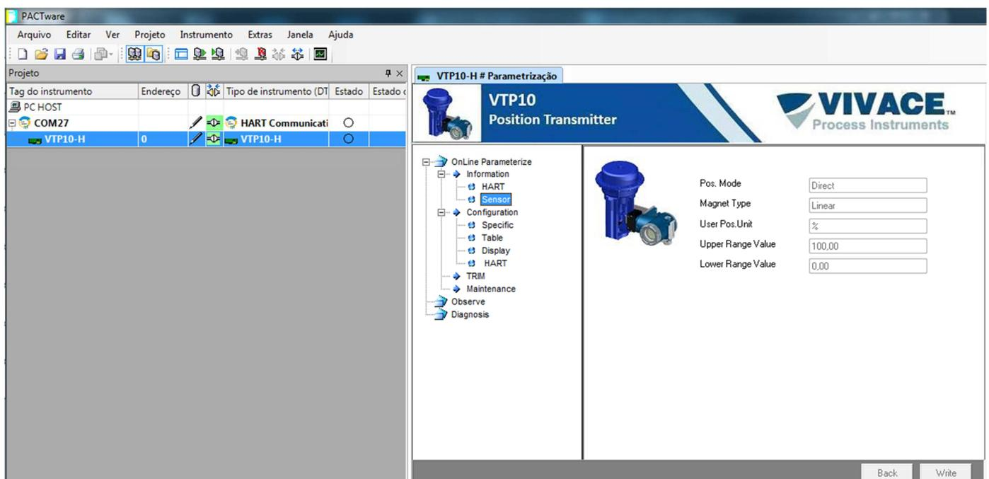
Figura 3.17 – Tela de configuração do sensor do VTP10-H no PACTware.
