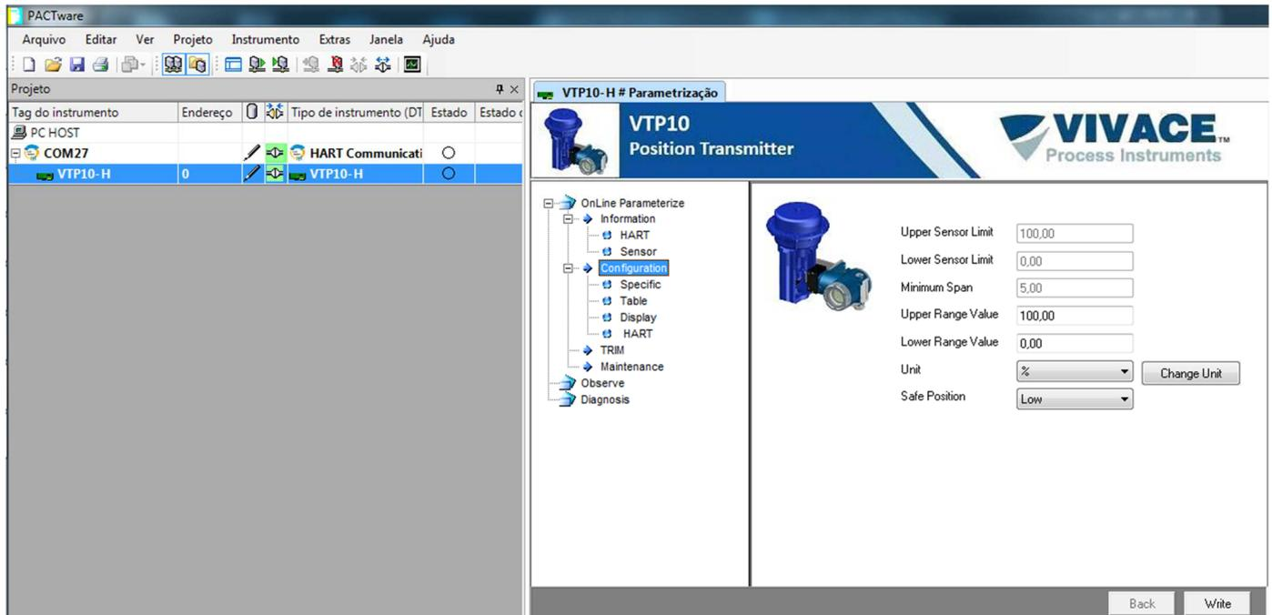
Figura 3.16 – Tela de configuração da faixa de trabalho do VTP10-H no PACTware.
