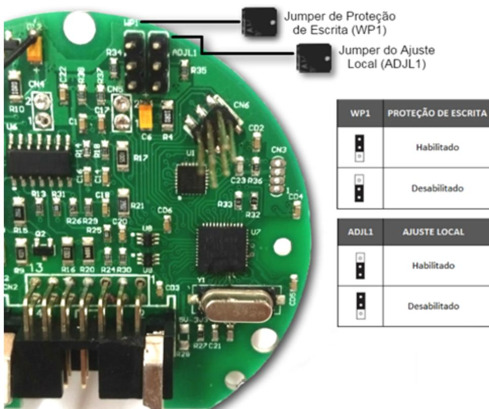
Figura 3.2 – Detalhe da placa principal com jumpers.
