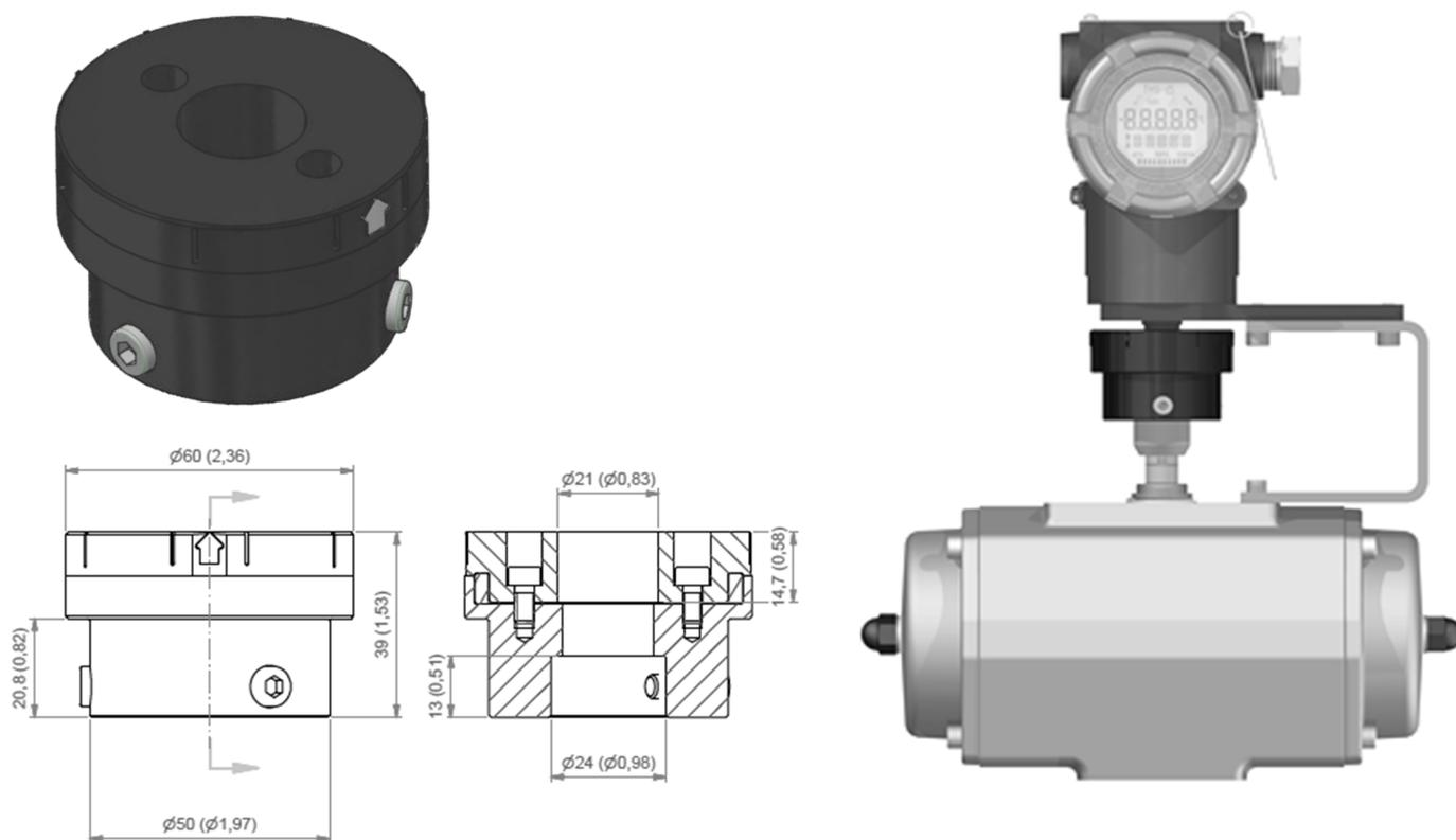
Figura 2.11 – Dimensional e montagem do ímã rotativo.
