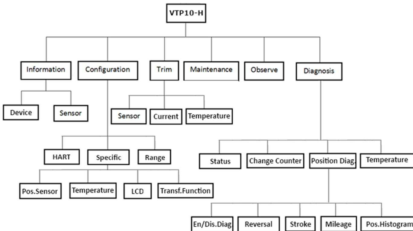
Figura 3.9 – Árvore de programação do VTP10-H.
