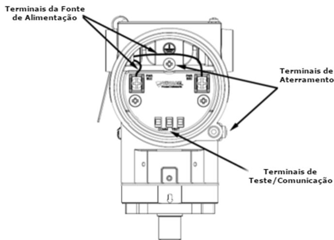
Figura 2.9 – Conexões e descrição dos terminais do VTP10-H.
