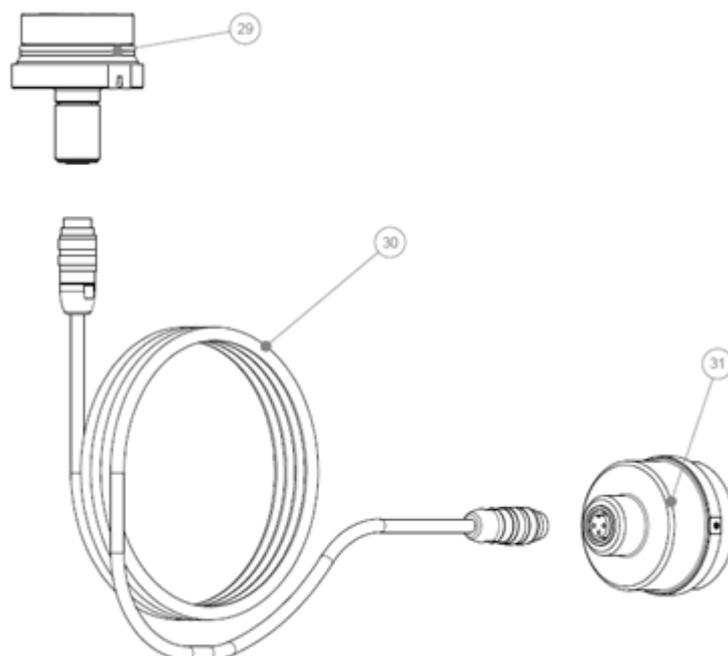
Figura 4.2 – Desenho explodido do sensor remoto do VTP10-H.
