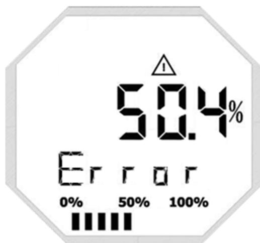
Figura 3.11 – Indicação de erro específico do VTP10-H.
